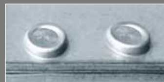
Tox moderní způsob spojování
