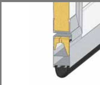
Nízký práh výška prahu 90+20 mm
