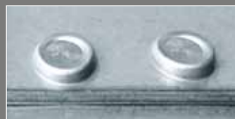
Tox moderní způsob spojování
